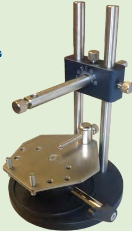
Dieses kleine Parallelometer ist ein einfaches und kompaktes Gerät, mit dem der Zahntechniker u.a. die Anker, ohne mit Fräsern arbeiten zu müssen, anbringen und Okklusionsebenen bestimmen kann. Es ist für Kurse geeignet.
