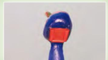
Zum Einbetten bereite Kappen mit Gusskanal und vergießbarer Führungsplatte.
