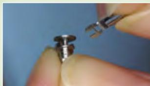
Den Schlüssel zum Verblocken in die Führung des vorgefertigten Gehäuses schieben. Auf diese Weise wird der Mechanismus (RIEGEL-RING) verblockt.
