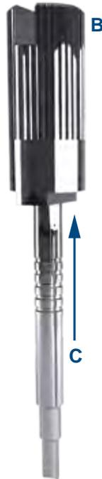
In die Positionierhilfe eingesetzte Reibahle (C) und Fräserhalter (B).
