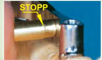
Die Positionierhilfe aus Messing in das Loch schieben und fixieren. Die STOPP-Markierung entspricht dem Volumen des vorgefertigten Gehäuses.
