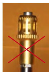
Nicht komplett aufgesetzter Schlüssel
